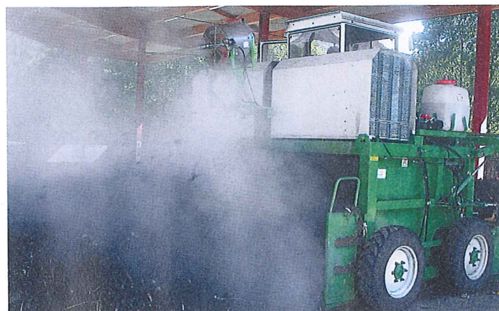
Neben der Fahrerkabine des Kompostumsetzers befindet sich der Kanister mit EMa-Verdünnung. Von dort wird die Flüssigkeit vor den Zerstäuber gepumpt und in das umzusetzende Material geblasen.
